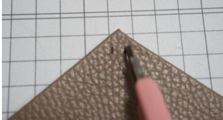
①本体外側部分に座金を利用して収まりを確認し、足の位置を決めて印を付ける。
